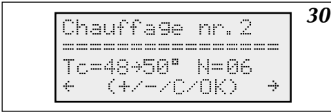
Figure 30 Page chauffage du deuxième circuit (Chauffage nr.2)
